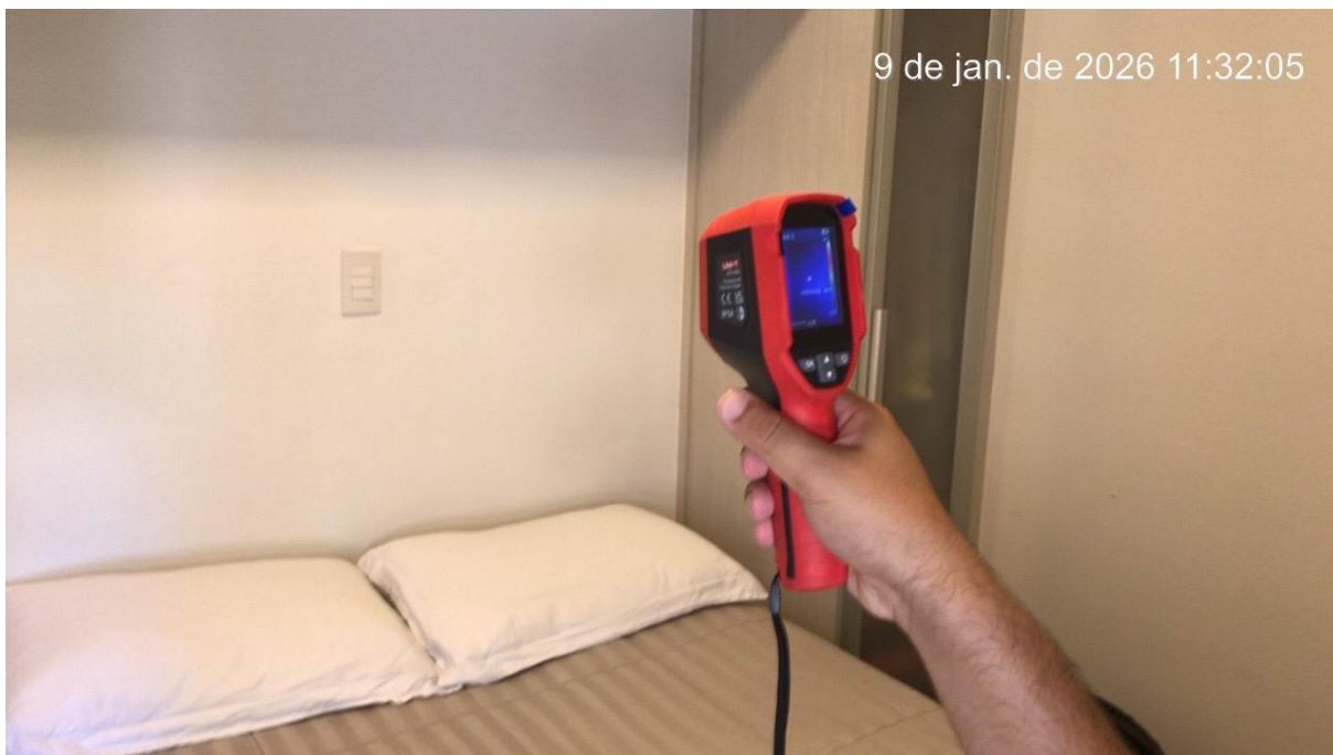
Figura 25 –A câmera termal não identificou sinais de umidade provenientes da fachada
